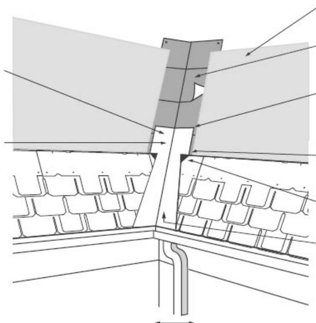
Уложите в желоб подкладочный материал Deck-Armor™ или иной корпорации GAF на гидроизоляционную мембрану с минимальным нахлестом 150 мм.
