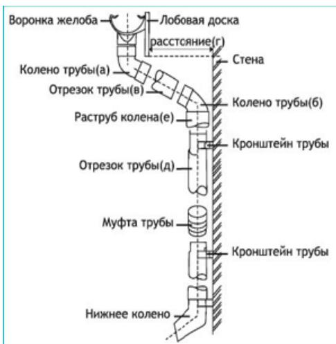
1. Монтаж водосточной трубы начинается с установки колена. Колено применяется при соединении воронок с водосточными трубами для огибания выступов фасада. Вставьте нижнюю часть воронки в колено трубы (а).
