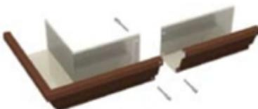
При соединении желобов или желоба с углом желоба срезают на 50 мм передний крючкообразный загиб желоба. На эту длину вставляют в него второй желоб.
