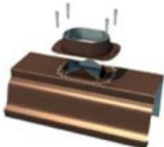
При необходимости отпиливают желоб до требуемой длины. В месте установки воронки в желобе делают Х-образный разрез, края которого загибают наружу, либо вырезают круглое отверстие диаметром 45-50 мм.
