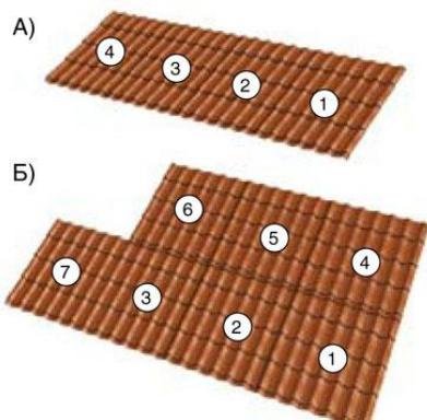
**Вариант 1:** Укладка металлической черепицы по длине листа, которая равна длине ската кровли (рис. А)
