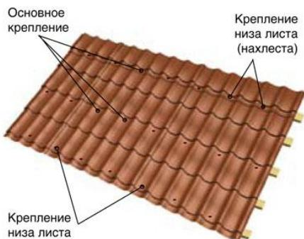
Листы металличерепицы крепятся саморезами 4.8x28 (4.8x35) с цветной головкой и ЭПДМ-прокладкой. При этом цвет головки самореза подбирается под цвет листа металличерепицы. Для надежного крепления их количество должно быть не менее 6-8 штук на 1 кв. м. металличерепицы.
