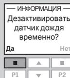
Датчик дождя будет отключен на 60 мин. Когда окно закроется, датчик дождя будет активирован снова.
