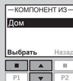
4 На дисплее отображается список всех компонентов, занесенных в директорию Дом. Тип компонента, в данном случае Окно, отображается на дисплее. Отдельные компоненты можно выбрать кратким нажатием кнопки . Произойдет кратковременная активация компонента.
