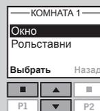
5 На дисплее отобразится список компонентов нужного типа.
