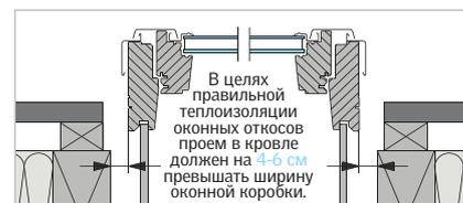
Необходимо утеплить откосы и зазор между оконной коробкой и конструкциями кровли.
