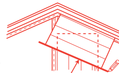
ИСПОЛЬЗУЯ КУСОК САЙДИНГА, ОТЧЕРТИТЕ ЛИНИЮ, ЧТОБЫ ОТРАЗИТЬ УГОЛ КРЫШИ
