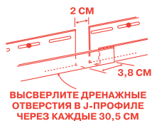
ВЫСВЕРЛИТЕ ДРЕНАЖНЫЕ ОТВЕРСТИЯ В J-ПРОФИЛЕ ЧЕРЕЗ КАЖДЫЕ 30,5 СМ
