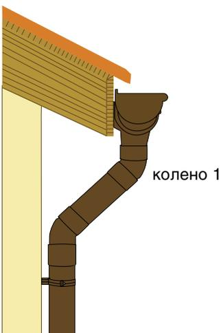
При наклонной крыше соединять два колена при помощи трубы длиной минимум 48 см.
