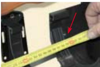
измерьте длину желоба до обозначения "limit position"
